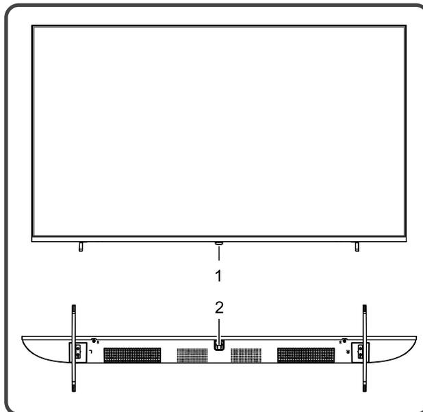
1. Indicador LED de encendido y ventana de recepción del control remoto.
